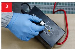
3 Sélectionner un bon niveau de chauffe avec Hot Stapler : Low, Medium ou High.
