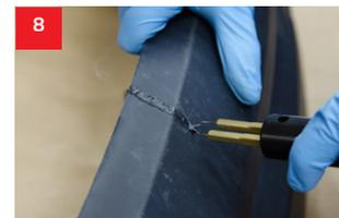
8 Avec une agrafe chauffée, fondre les bouts endommagés.
