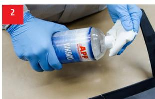
2 Avant de commencer la réparation, décaper et dégraisser la surface à traiter avec WK900.
